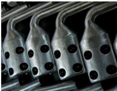
nedostaci u kvalitetu legura i njihov uticaj na funkcionalnost priključnih stezaljki u praktičnoj primeni u visokonaponskim elektroenergetskim postrojenjima. Zauzet je čvrst stav da se strujne stezaljke moraju praviti isključivo od čistog aluminijuma i bakra, a nikako od komercijalnih legura koje su kratkog veka trajanja i niske provodljivosti, a koje se nažalost još uvek široko koriste.
